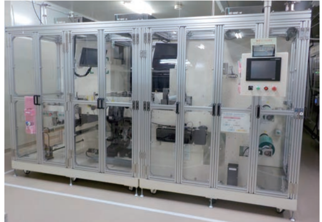
静電気印加試験を行う電気検査装置。グンゼはこうした設備も自社で保有している
